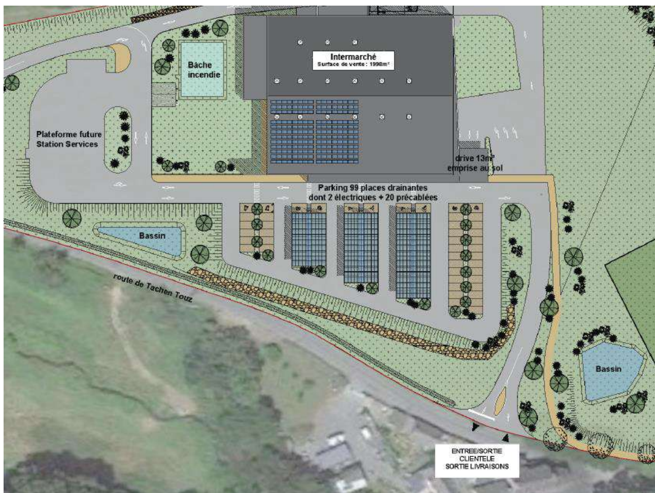
Figure 59 : Gestion des eaux pluviales initiale
